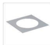
Art.-Nr. 7000.1053.185 Verstärkungsplatte für den sicheren Einbau in Odenwald- und Akkustik-Decken, verzinkt, Abmessung 619 x 619 mm, Ausschnitt 185 mm, (Abb. ähnlich)
