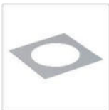
Art.-Nr. 7000.1053.130 Verstärkungsplatte für den sicheren Einbau in Odenwald- und Akustik-Decken, verzinkt, 250 x 250 mm, Ausschnitt 105 mm, (Abb. ähnlich)
