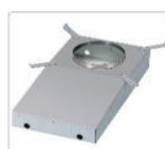
Art.-Nr. 9590.LA20 Betoneingießarmatur, passend zu BLICKLICHT-Leuchten LA20..., incl. Haltelaschen mit Nagellöchern zur Fixierung auf der Verschalung bzw. zur Befestigung an der Armierung, (Abb. ähnlich)
