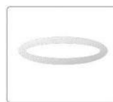
Art.-Nr.: AR180W144 Ausgleichsring für die Sanierung zum Einsatz der Leuchte LA 16 in größere, vorhandene Deckenausschnitte 150-165 mm, Oberfläche weiß Feinstruktur, D = 180 mm, Ausschnitt 144 mm, inkl. Stützlaschenverlängerungsset MS. Für größere Deckenausschnitte fertigen wir Ausgleichsringe mit Einbaufedern nach Vorgabe. Bitte angeben: vorhandener Deckenausschnitt, gewünschter Aussendurchmesser (Einbautiefe beachten!)
